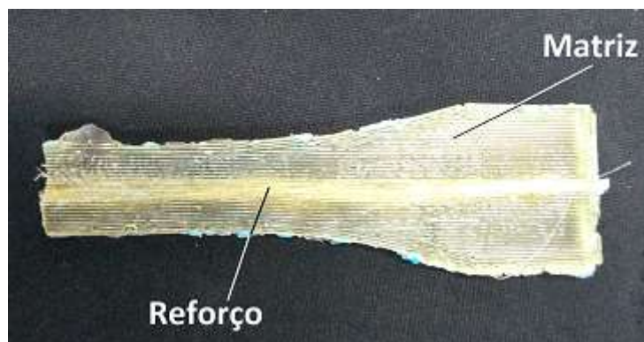
Figura 2.6: Corpo de prova no formato osso de cão feito de material compósito após ensaio de tração.
