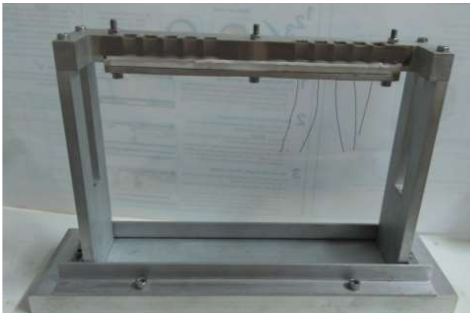
Figura 3.4: Molde montado para os corpos de prova usados no ensaio de Pullout.
