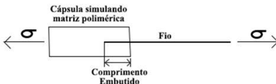
Figura 3.3: Corpo de prova para o ensaio de Pullout. (MONTEIRO et al. ,2006)
